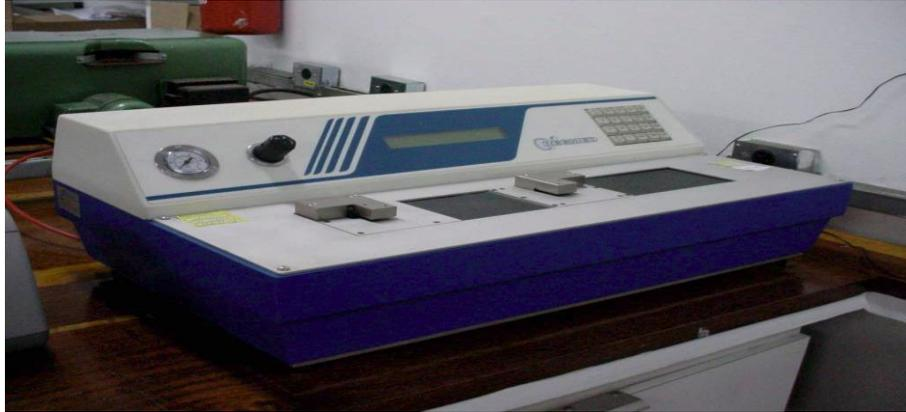
**Figura 14-** Medidor de tração horizontal DI 500 (Regmed), fonte: SENAI, Tecnologia de Fabricação de Papel, vol. II, 2º edição.
