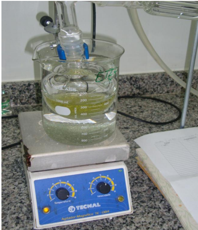
Figura 1- Aquecimento da destilação éter etílico contaminado.
