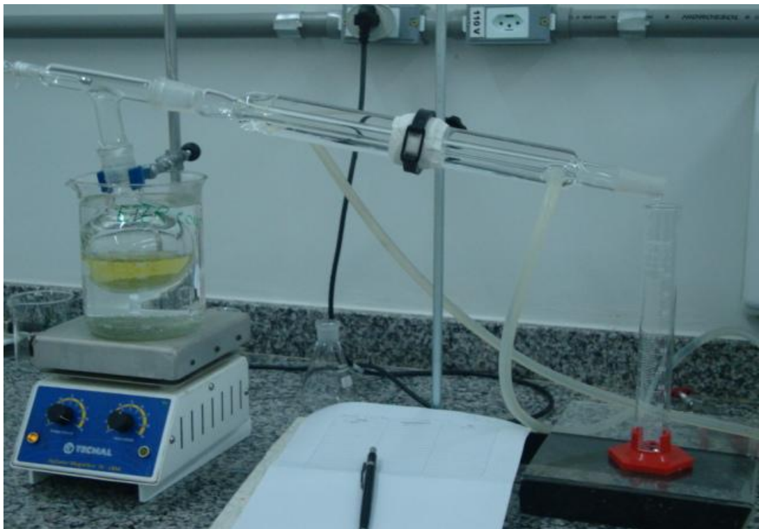
Figura 2 - Destilação do éter etílico contaminado.
