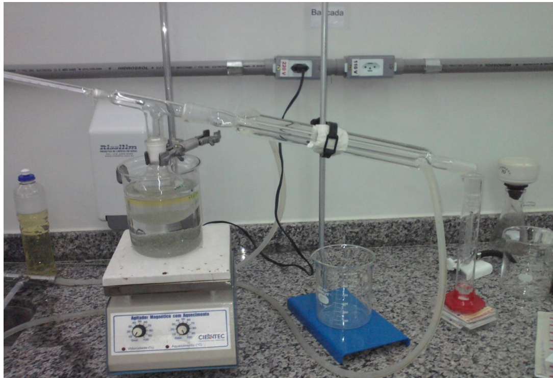
Figura 3 - Destilação do éter etílico contaminado diluído em água.
