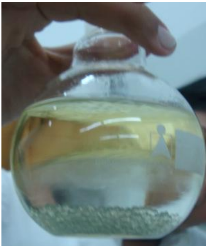
Figura 04- Éter etílico contaminado diluído em água destilada.
