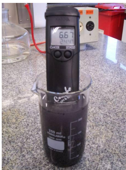
Figura 3- Leitura do pH na amostra de solo
