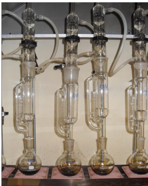
Figura 4- Extração do Hexano no Ensaio de Óleos e Graxas
