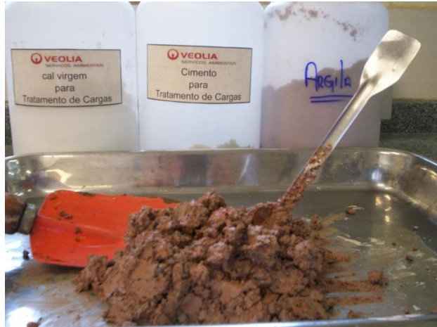
Figura 14- Tratamento do solo em laboratório com adição da Argila, Cimento e Cal Virgem
