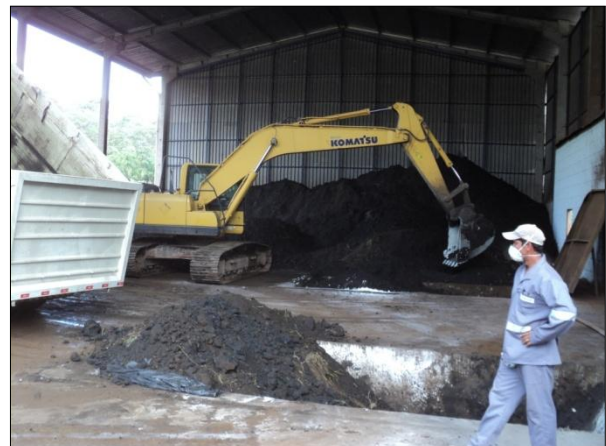
Figura 16- Adição da Argila
