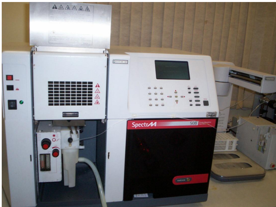
Figura 11- Equipamento de Absorção Atômica
