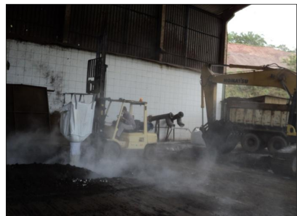
Figura 18- Adição do Cimento e Cal Virgem
