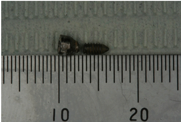
Figura 8 – Fratura do parafuso do pilar
