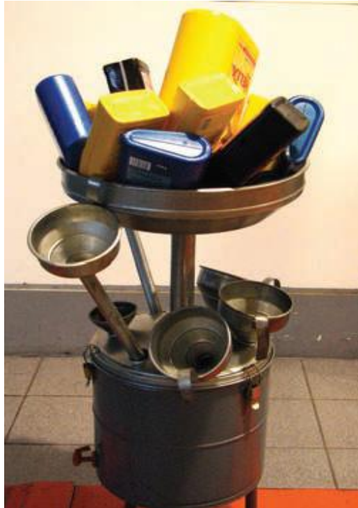
Figura 9: Equipamento para escoamento de óleo lubrificante Fonte: FIESP (2007)
