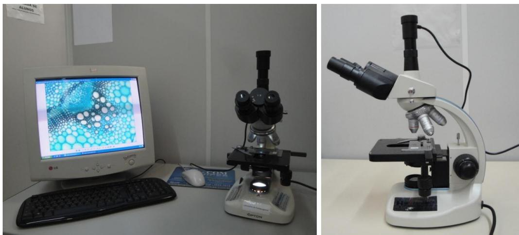
Figura 02 - Microscópio triocular e Ocular digital de alta resolução (TA-0124-A, Option)
