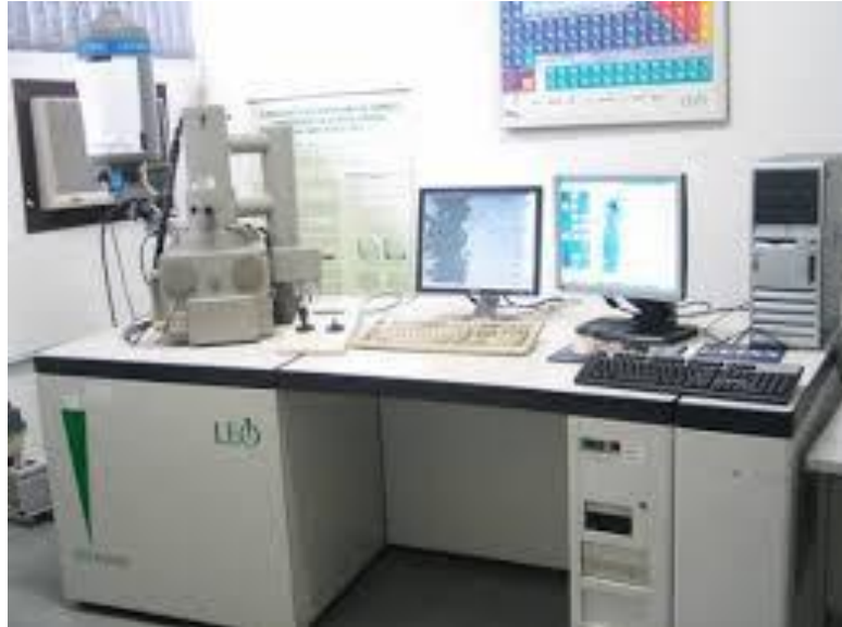
Figura 9- Equipamento modelo 435 VPI da marca LEO, acoplado a um Analisador por Energia Dispersiva de Raios X
