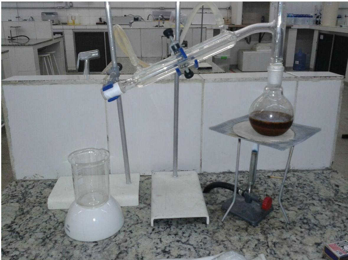
Figura 7 - Sistema de destilação simples, com princípios de hidrodestilação.
