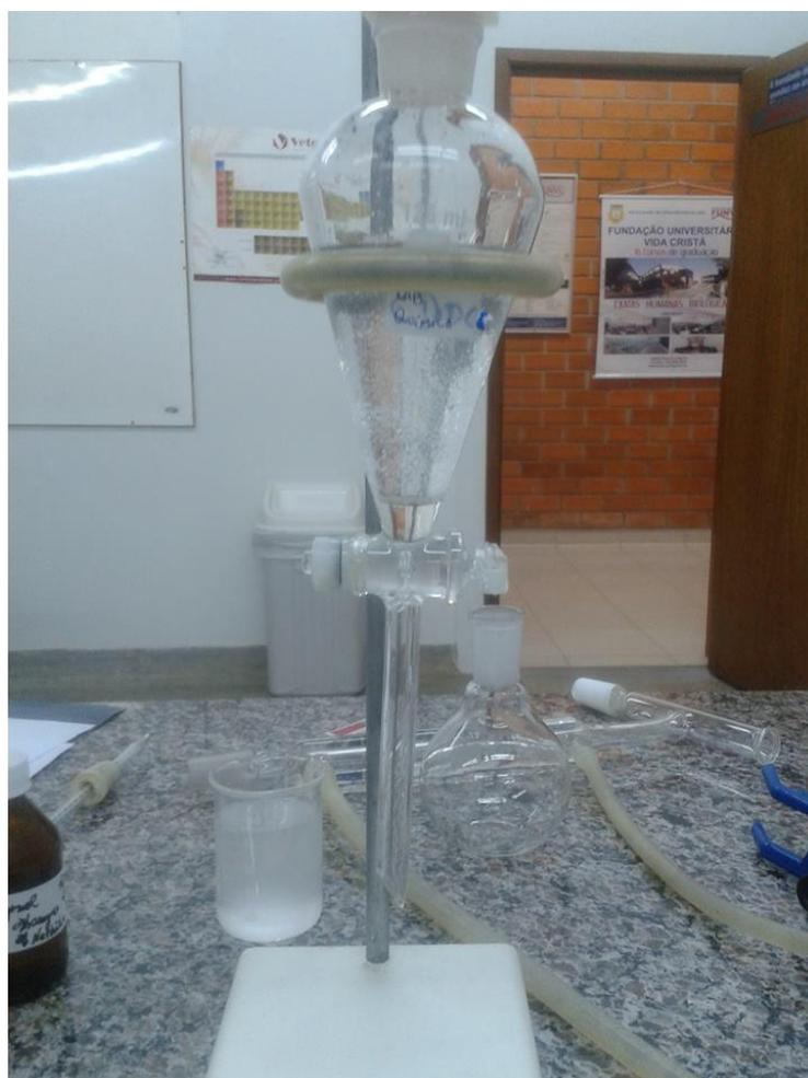
Figura 8 - Funil de separação contendo a mistura óleo-água.
