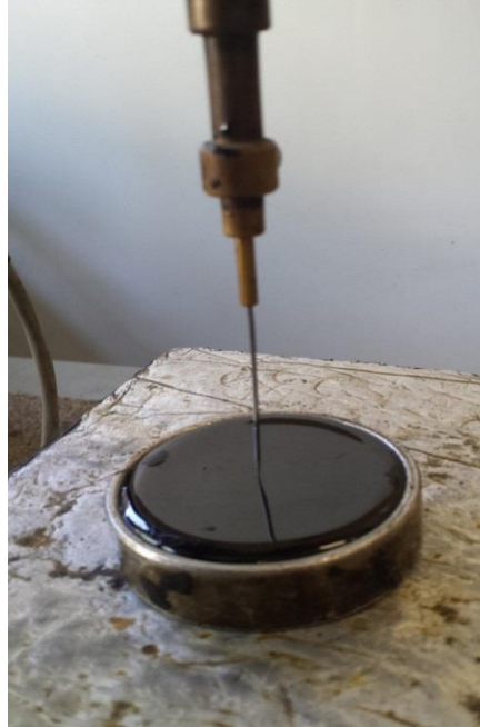
Figura 2- Ensaio de Ponto de penetração
