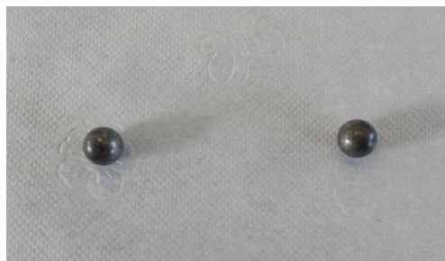
Figura 4 - Esferas utilizadas no ensaio de determinação do ponto de amolecimento
