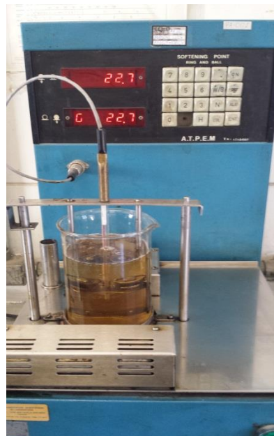
Figura 6 - Preparação para a análise de ponto de amolecimento
