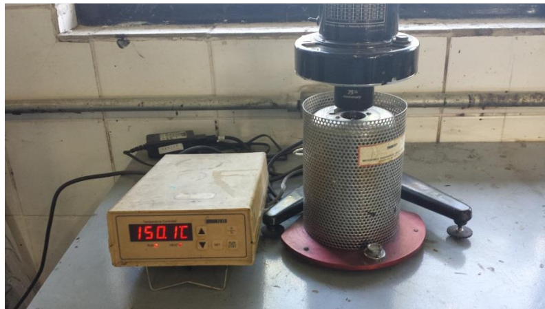
Figura 9 - Aparelho viscosímetro de Brookfield modelo RVT acoplado ao Thermosel
