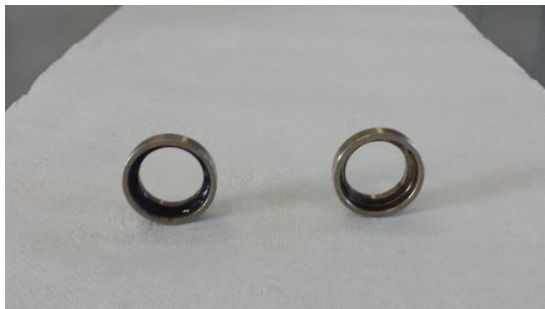
Figura 3- Anéis utilizados no ensaio de determinação do ponto de amolecimento
