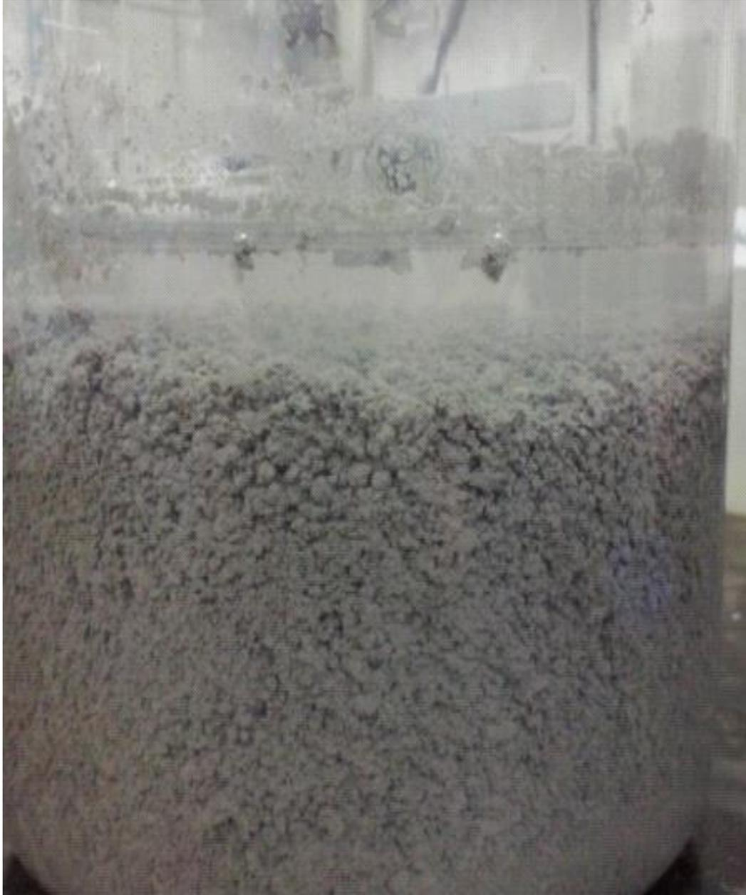
Figura 2 - Resultado de coagulação com Policloreto de Alumínio (PAC)
