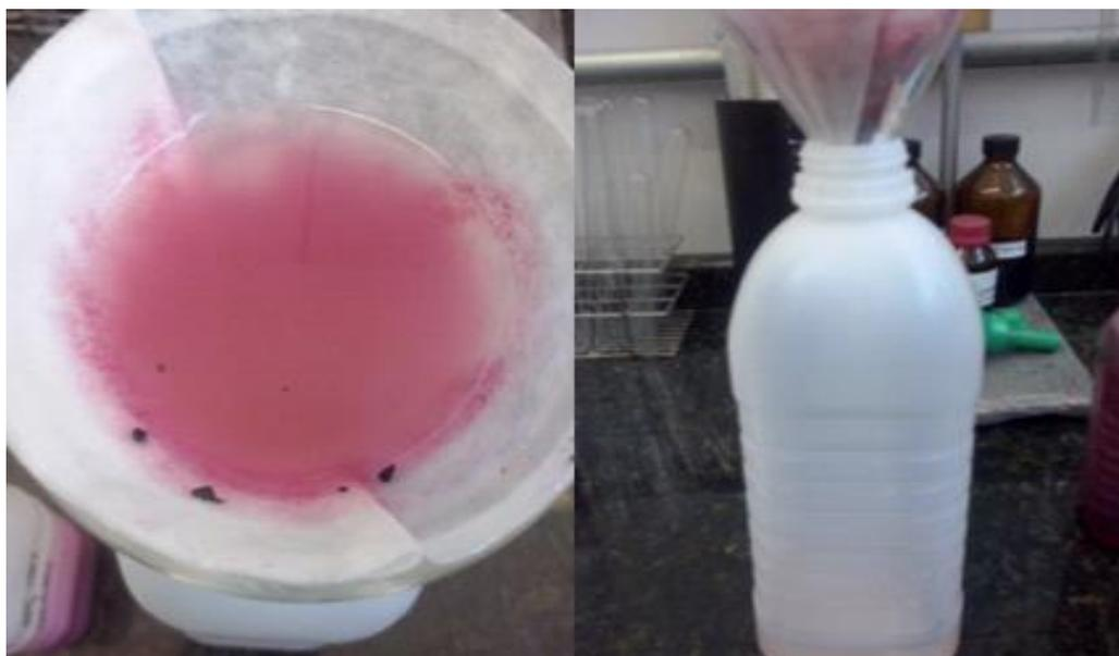
Figura 6 - Filtração para retirada do carvão ativado e outros sólidos dispersos
