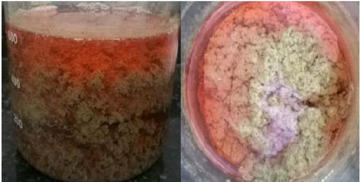
Figura 4 - Resultado da coagulação e floculação do efluente
