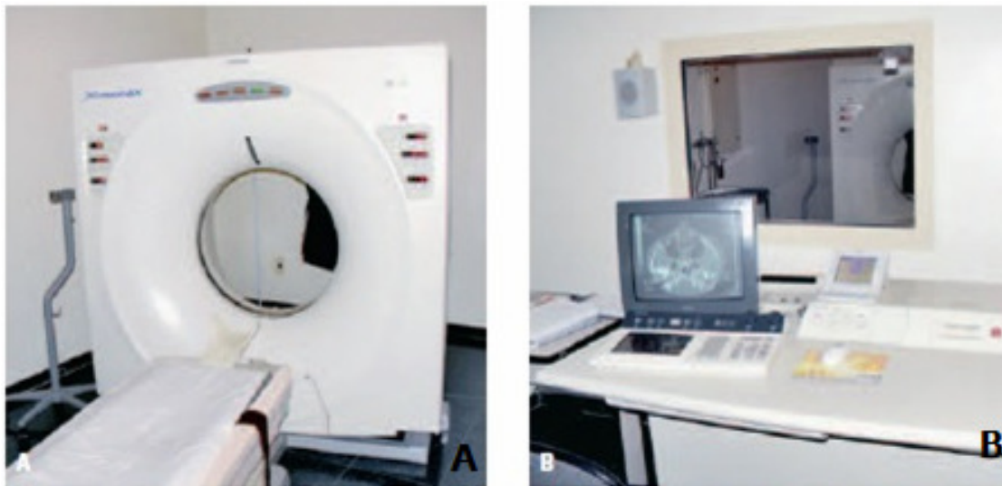
Figura 1 – Aparelho de Tomografia Computadorizada Tradicional. A. gantry e mesa; B. Computador 1
