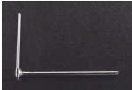
Figura 16- Coloque a “trava molar” na parte menor de tubo do “tubo T”.
