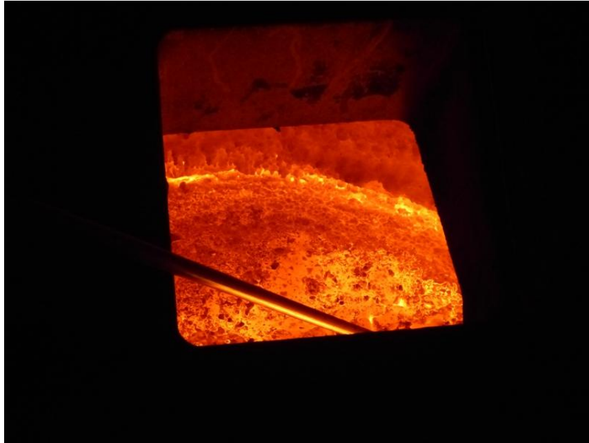
Figura 4. Escória em Refino Secundário (Forno Panela).
