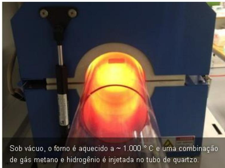
Sob vácuo, o forno é aquecido a  $\sim 1.000^\circ\text{C}$  e uma combinação de gás metano e hidrogênio é injetada no tubo de quartzo.
