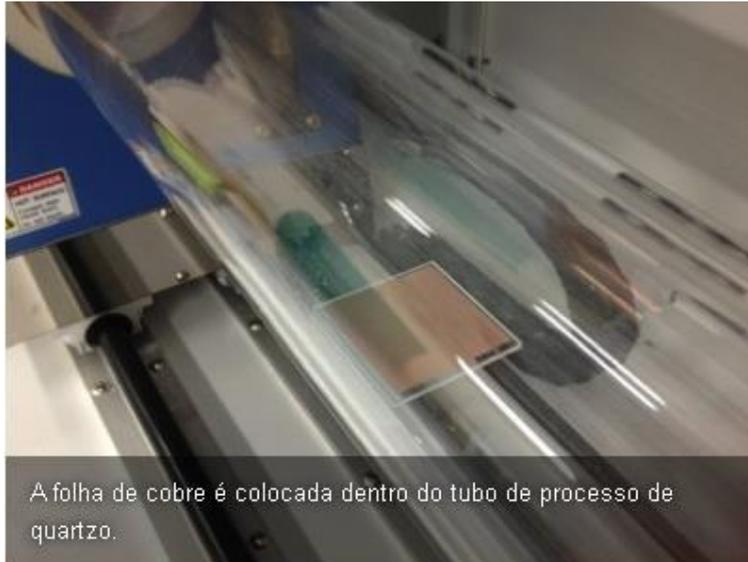
A folha de cobre é colocada dentro do tubo de processo de quartzo.
