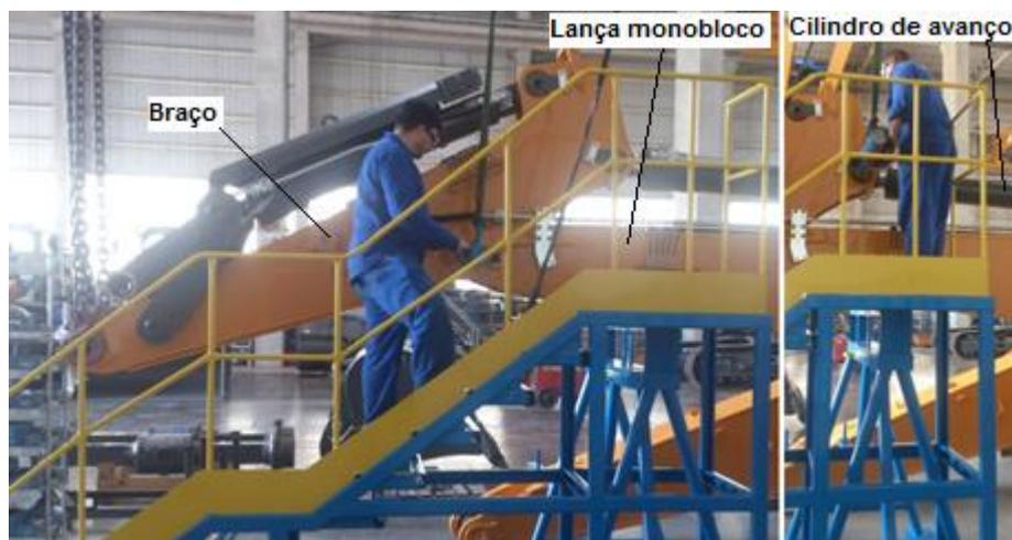
Figura 28 - Atividade executada após a implantação da escada acoplada ao cavalete
