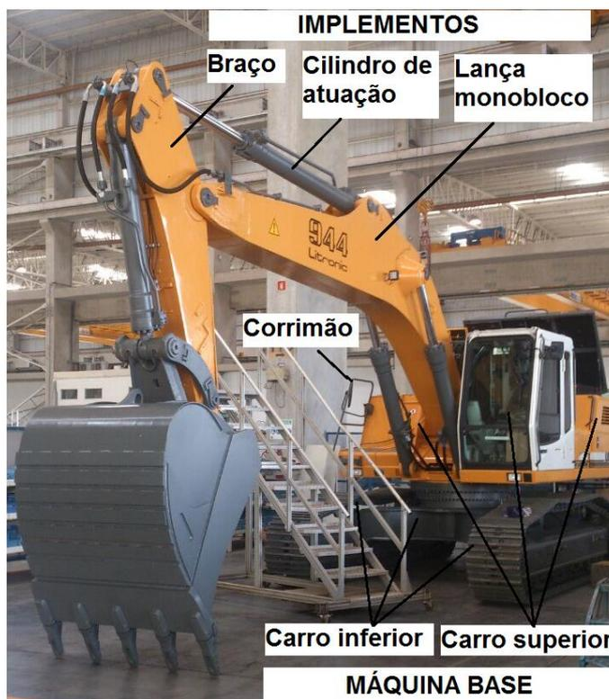
Figura 1 - Retroescavadeira hidráulica e suas principais partes
