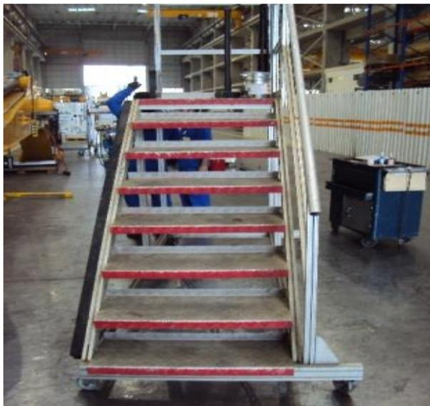
Figura 5 - Escada com altura máxima de 1.700 mm
