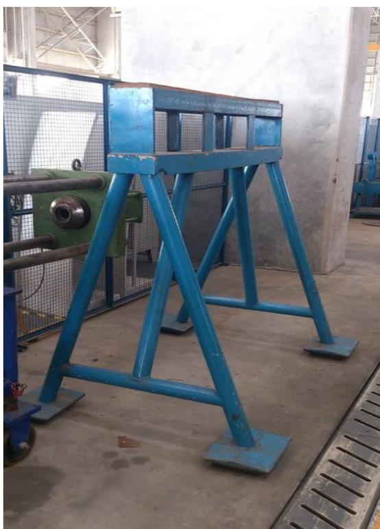
Figura 6 - Cavalete com altura de 1.800 mm
