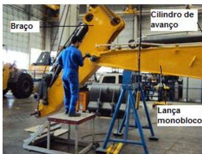
Figura 9 - Pinagem da lança monobloco com o braço
