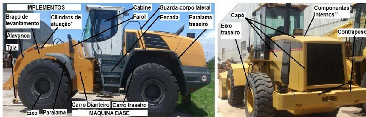
\* Cilindros de atuação: cilindro de basculamento, cilindro de elevação e cilindro de direção
