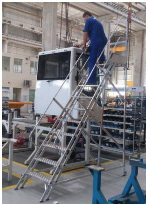
Figura 24 - Montagem da cabine (fixação de ganchos) – após implementação
