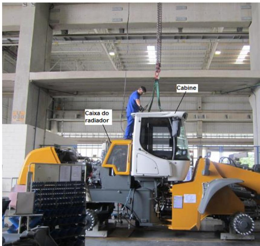
Figura 25 - Montagem da cabine (retirada de ganchos) – antes da implementação
