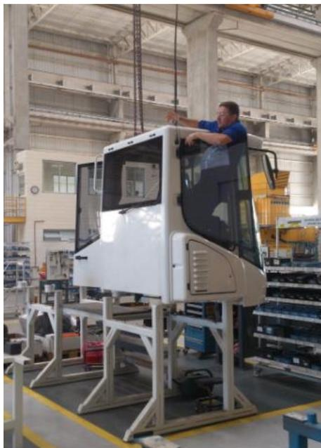
Figura 23 - Montagem da cabine (fixação de ganchos) – antes da implementação
