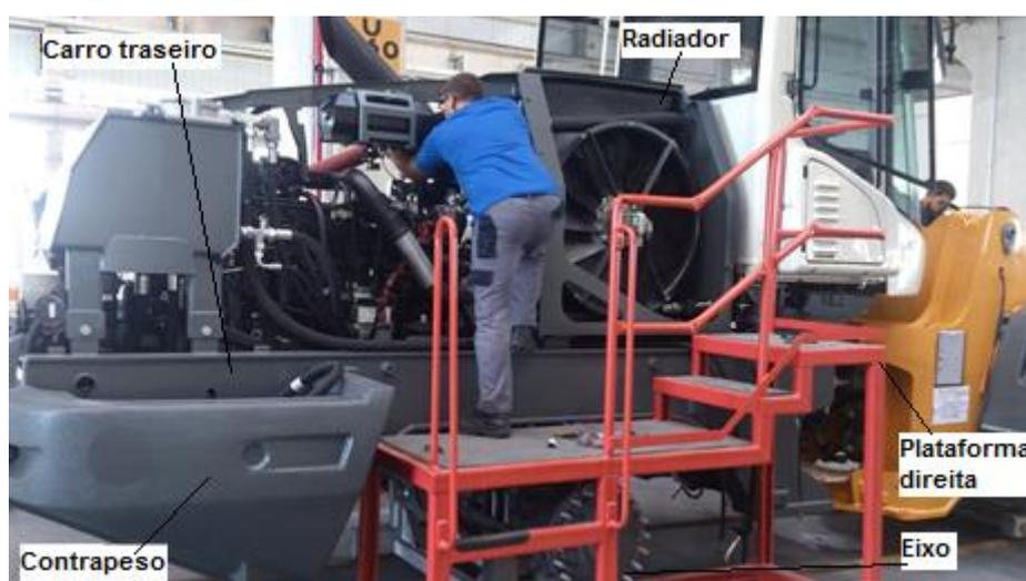
Figura 22 - Atividade sendo executada após implantação das plataformas (protótipo)
