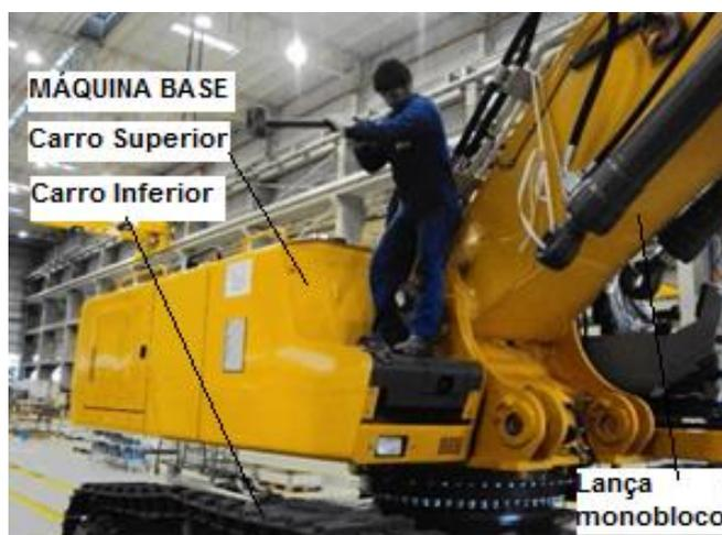
Figura 12 - Pinagem da máquina base com a lança monobloco
