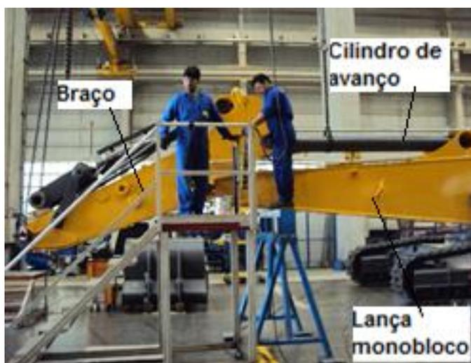
Figura 10 - Pinagem do braço com o cilindro de avanço (ajuste do pino)
