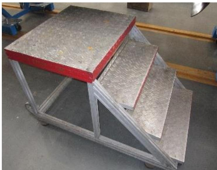
Figura 4 - Escada com altura máxima de 740 mm
