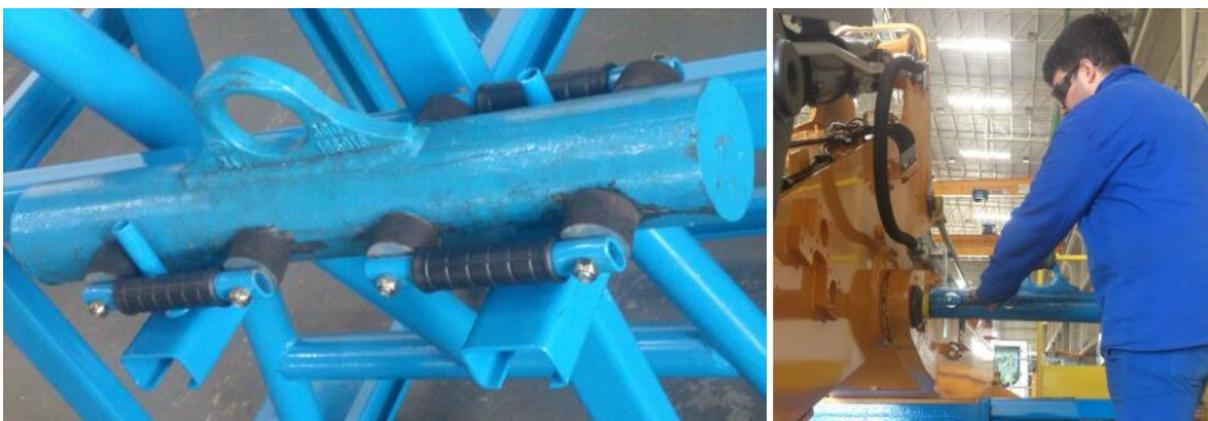
Figura 20 - Dispositivo para pinagem
