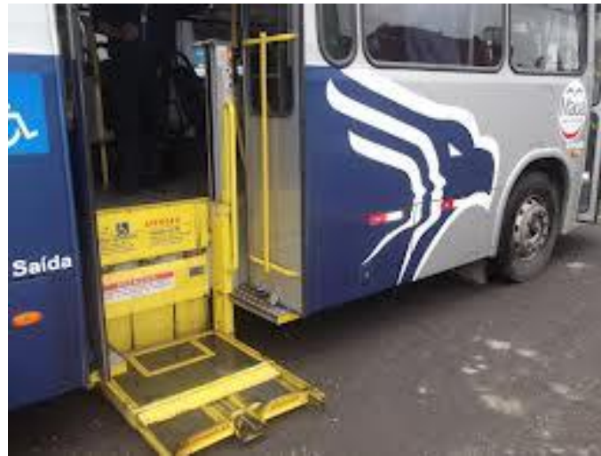
Figura 3: Elevadores para pessoas com necessidades especiais
