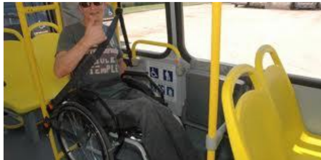
Figura 4: cintos de segurança, local apropriado para cadeirantes, corrimão e equipamentos ao alcance do portador.
