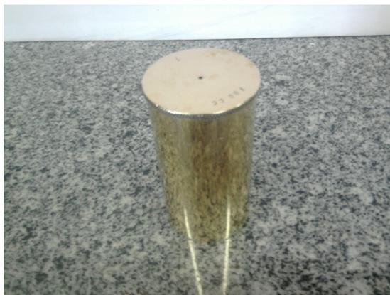
Figura 11 – Fotografia do Densímetro (picnômetro)
