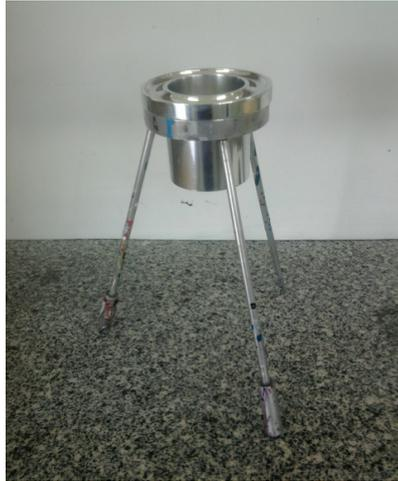
Figura 10 – Fotografia do Viscosímetro copo Ford 4
