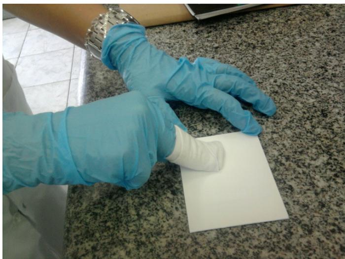
Figura 16 – Fotografia do ensaio para determinar o grau de cura do filme de tinta
