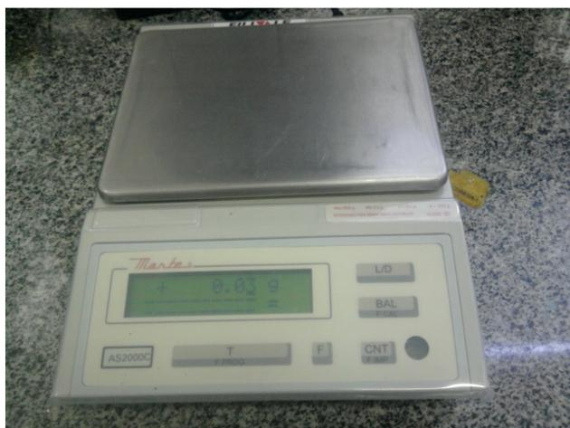
Figura 9 – Fotografia da Balança analítica
