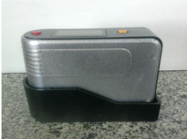
Figura 13 – Fotografia do *Gloss Meter* – medidor de brilho
