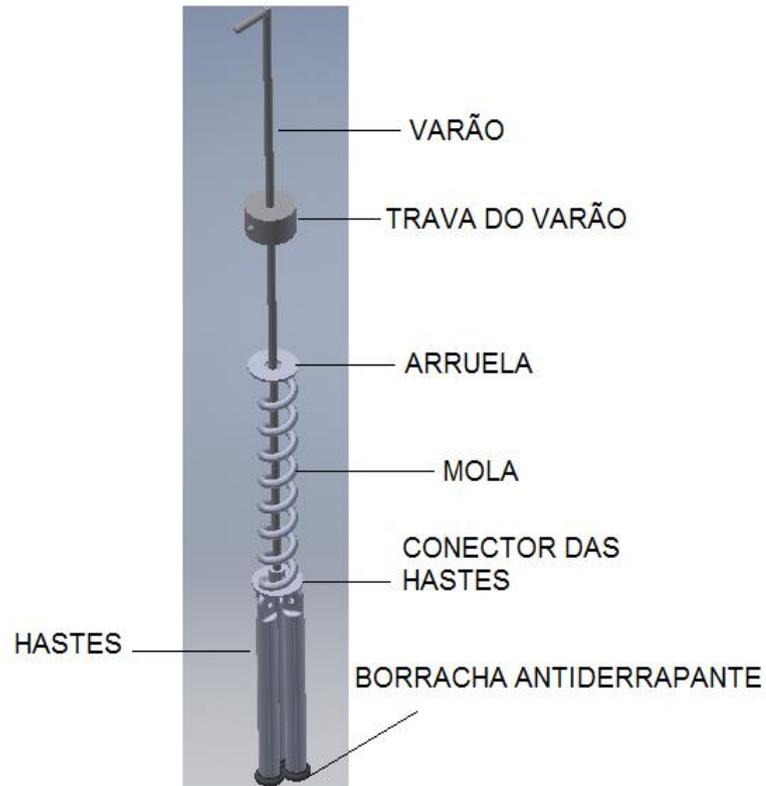
Figura 14- Visão tridimensional do dispositivo.
