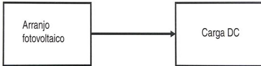
**Figura 3.8** - Sistema fotovoltaico diretamente acoplado
