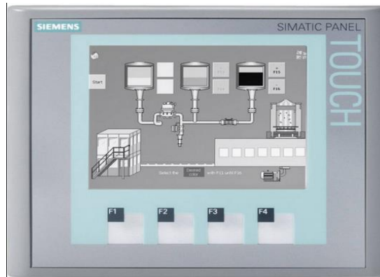
Figura 10 - IHM (Interface Homem-Máquina)
