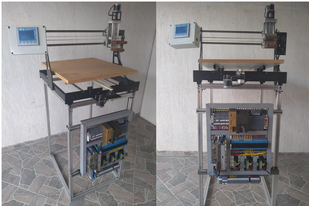
Figura 62 - Mesa CNC Tridimensional XYZ
