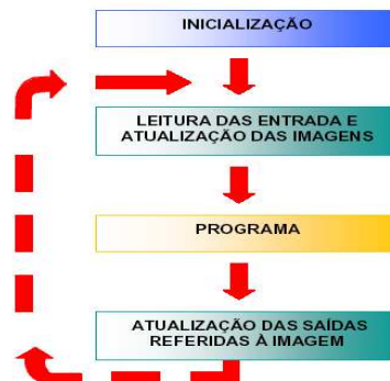
Figura 1-Ciclo de processamento do CLP
