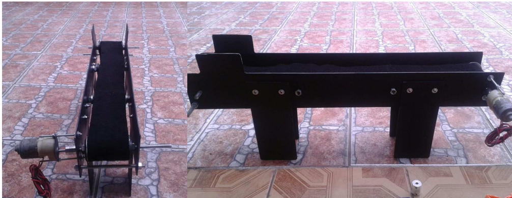
FIGURA 9: Foto da esteira sendo montada.
