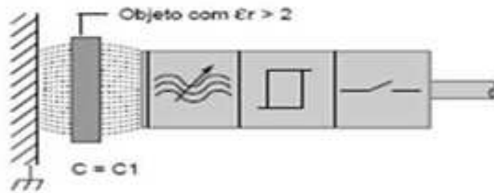
FIGURA 6: Estrutura do sensor capacitivo.
