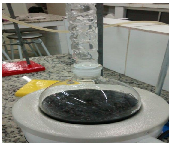
Figura 12 – Destilação do álcool com impurezas
