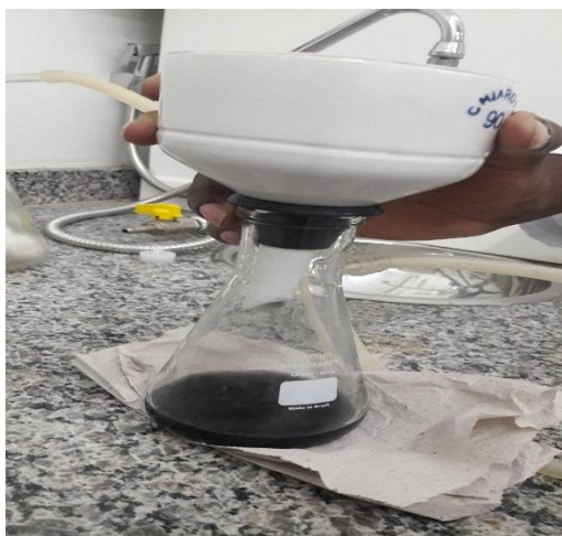
Figura 9 – Resultado da filtração a vácuo
