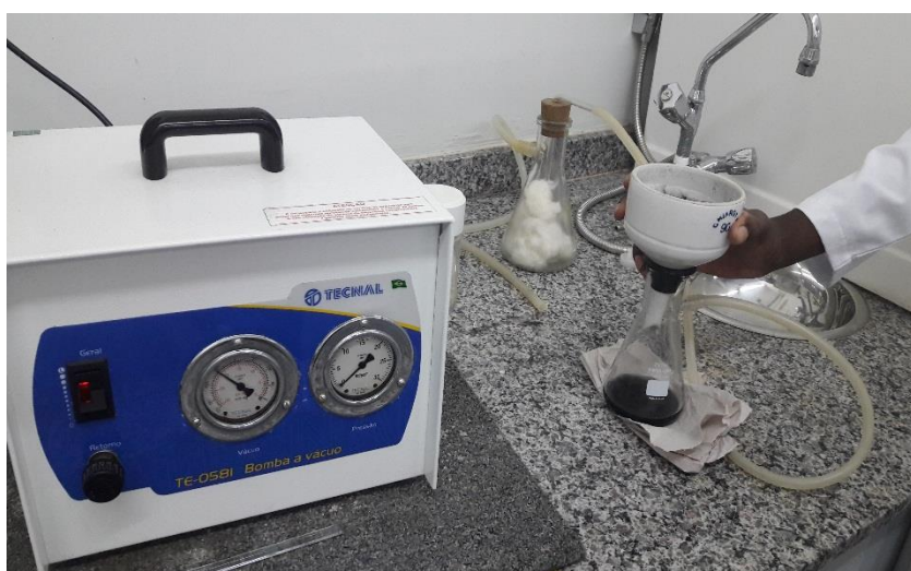
Figura 3 – Filtração a vácuo
