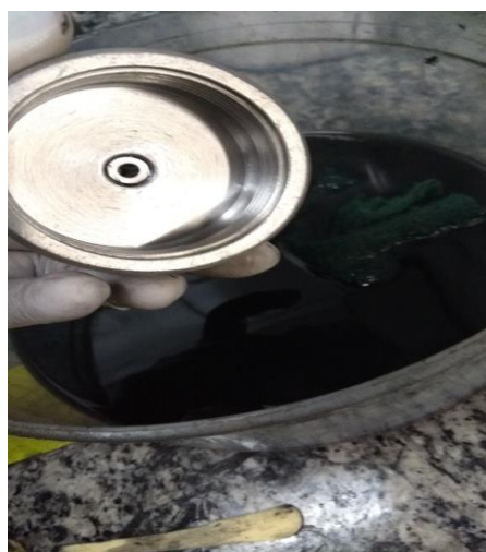
Figura 16 – Peça após a limpeza com álcool purificado
