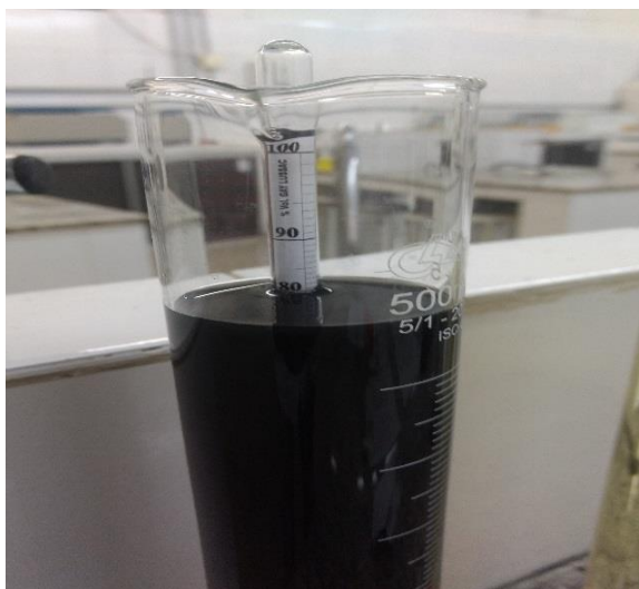
Figura 10 - Álcool etílico antes da filtração (80° GL)
