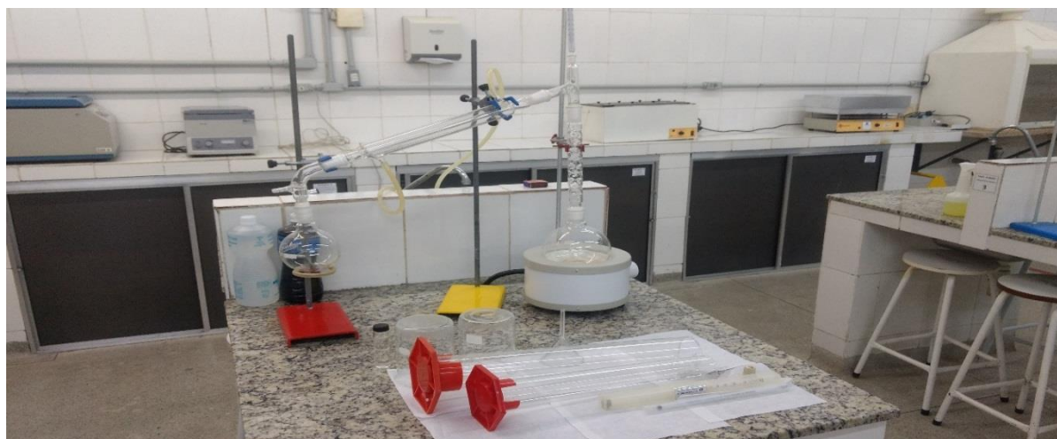
Figura 7 – Aparelhagem utilizada para realização da destilação fracionária
